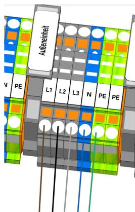
2. PVC-Schlauchleitung H05VV-F 3G × 0,75 (230 V Primärkreispumpe) an Klemmleiste X Primärkreis Pumpe L1, N, PE korrespondierend anschließen.
